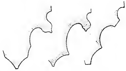
FIG. 324. — Profils d'arcs ou de piédroits flamboyants.
